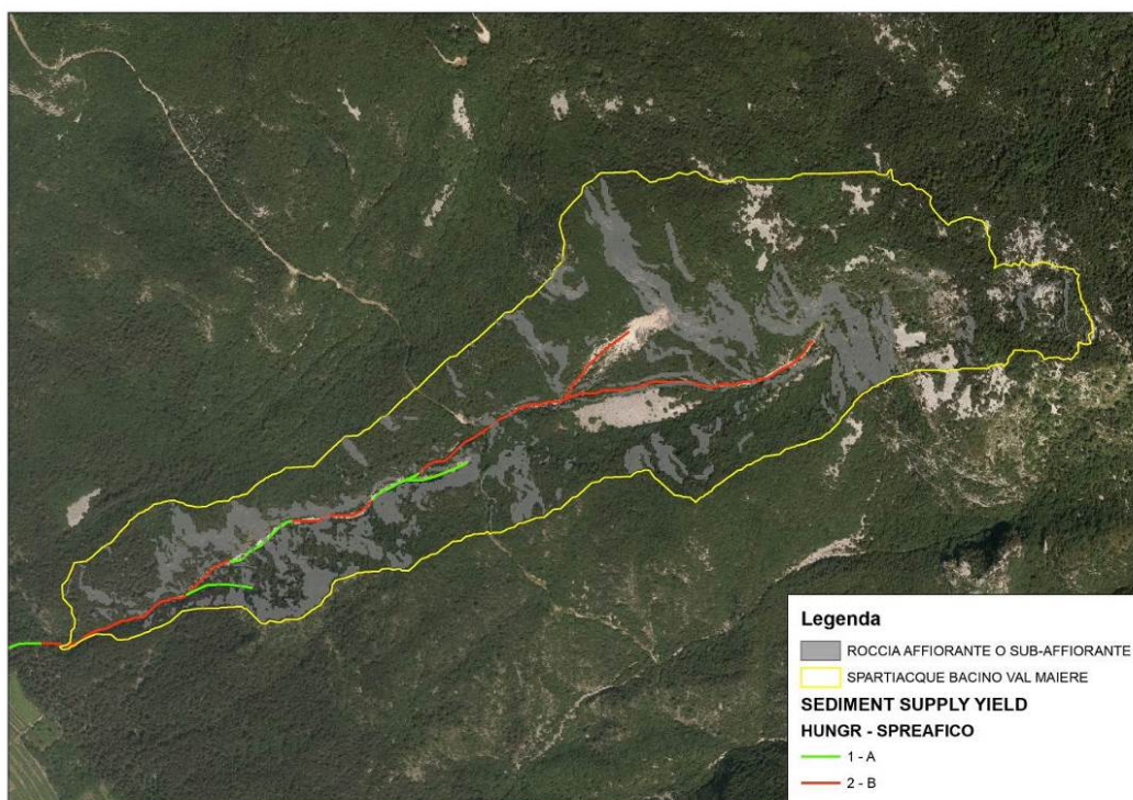
Fig. 4.15 – Classificazione dei canali detritici attivi secondo i criteri di Hungr (1984) e Spreafico (1999)
