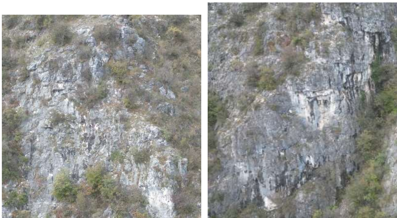
Figura 16 Settore C - Particolare stato di fratturazione dell'ammasso
